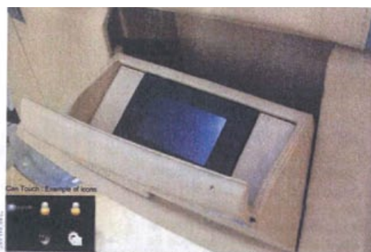
Oxytronic développe des boîtiers de commande de systèmes de divertissement en vol pour hélicoptère.
