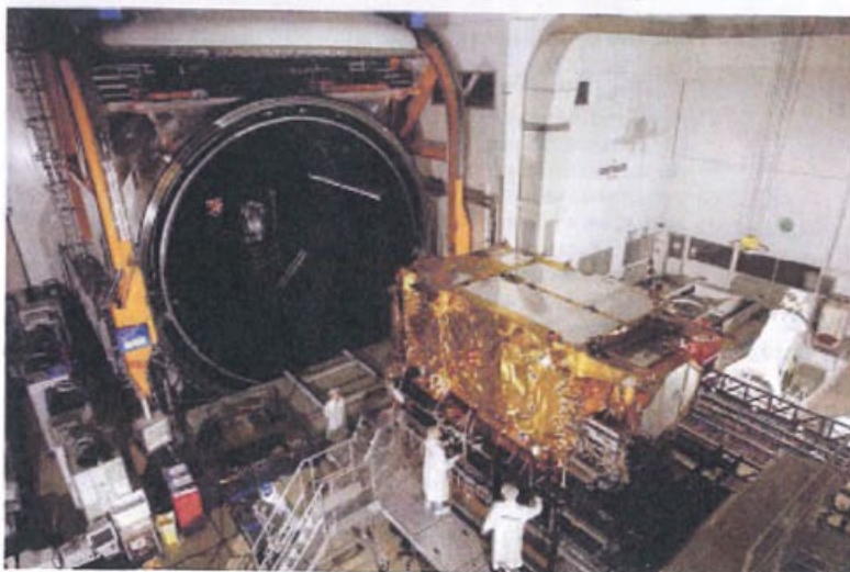
Conduites d'essais thermiques chez Thales Alenia Space par Technicom sur le satellite Syracuse.
